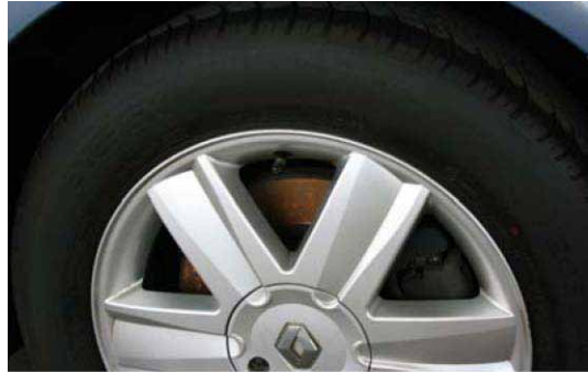
La corrosion du disque au V.O.
